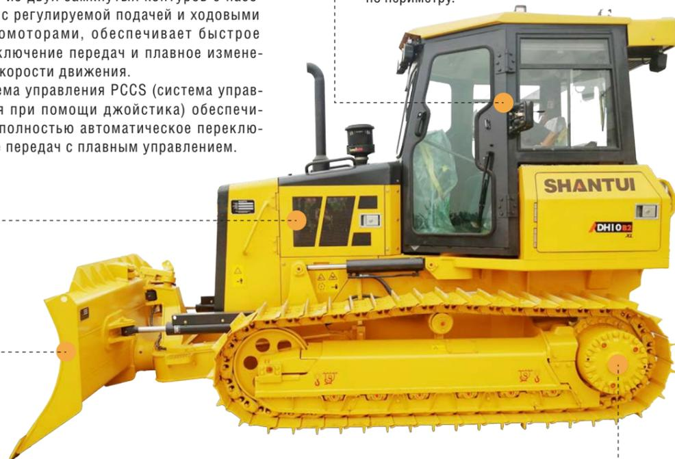
PAT blade – отвал с регулируемыми углами поворота и перекоса, отличается прочной конструкцией, увеличивает производительность и расширяет возможности применения бульдозера в различных отраслях. PPC – система пропорционального управления давлением, при помощи джойстика обеспечивает плавность и устойчивость перемещения отвала. Эргономика джойстика обеспечивает более точное управление при меньших физических нагрузках оператора.
